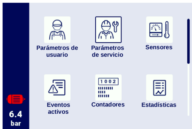
Figura 6 Menú principal del controlador AirVision One
