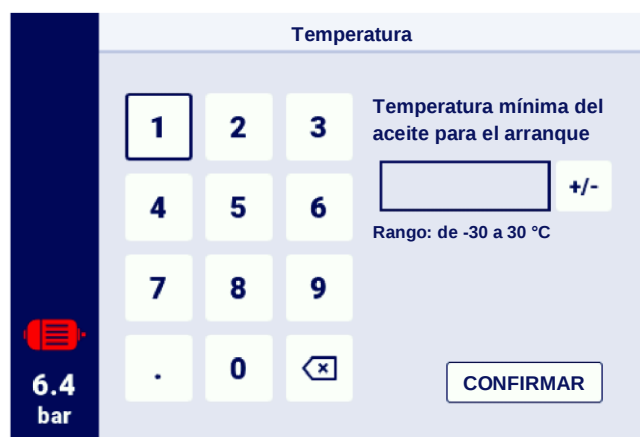
Figura 13 Teclado de pantalla sobre el ejemplo de la temperatura mínima del aceite para el arranque
