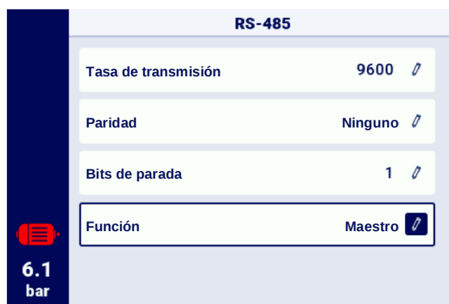
Figura 43 Menú de configuración del puerto RS-485
