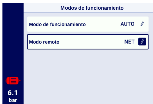
Figura 44 Menú de configuración del modo remoto
