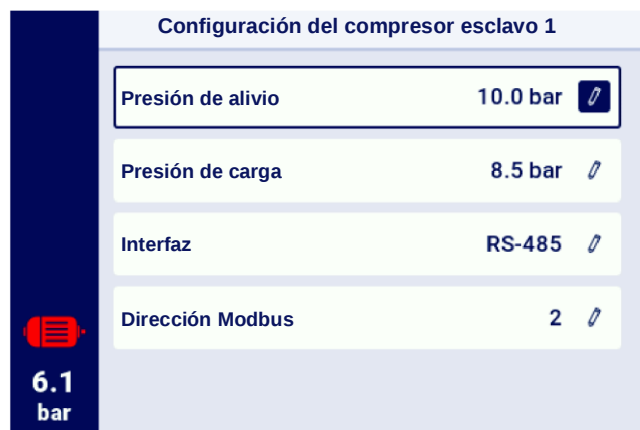
Figura 42 Menú de configuración del compresor esclavo 1
