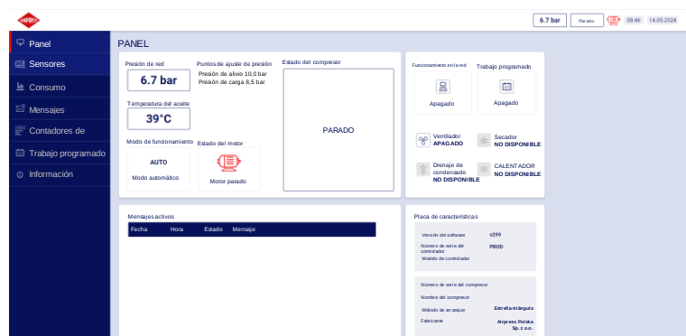
Figura 47 Vista del panel del servidor web
