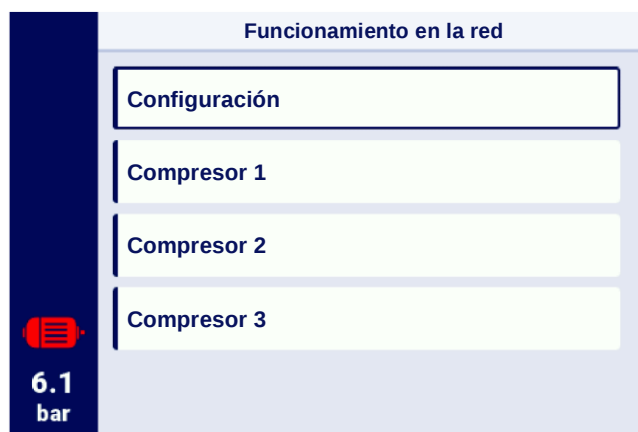
Figura 41 Menú de funcionamiento en la red
