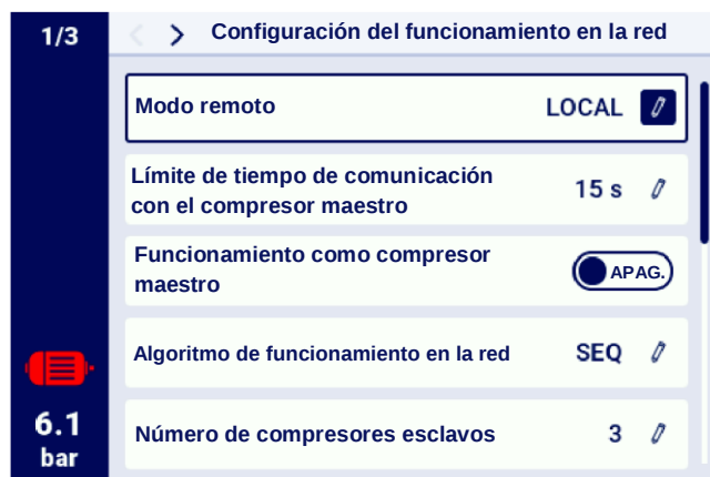
Figura 12 Mosaicos con parámetros tomando como ejemplo un subgrupo de parámetros de configuración de funcionamiento en la red
