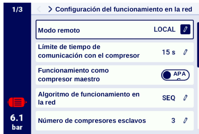
Figura 38 Menú de configuración de funcionamiento en la red 1/3
